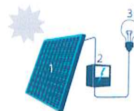
1 Zonnepaneel | 2 Omvormer 3 Elektrische toestellen
